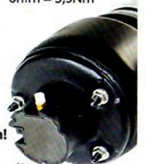
Bei 4mm / 6mm Druckluftschlauch darf ein Anzugsmoment von 2Nm / 3,5Nm nicht überschritten werden!
